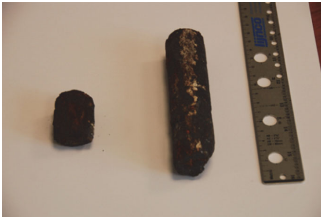
Bild 10 Von den gebrochenen Spanngliedern zur metallurgischen Analyse entnommene Proben Samples taken from the fractured tendons for metallurgical analysis
