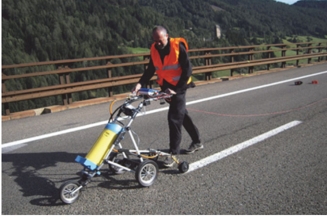
Bild 11 Für die Potentialfeldmessungen verwendete Ausrüstung Equipment used for the potential measurements
